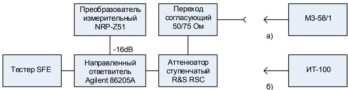
Рисунок 3 а) определение значений опорной мощности;
